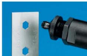
Pieza de trabajo con taladros hexagonales punzonados por la 74290, preparados para colocar las tuercas remachables Hexsert®
