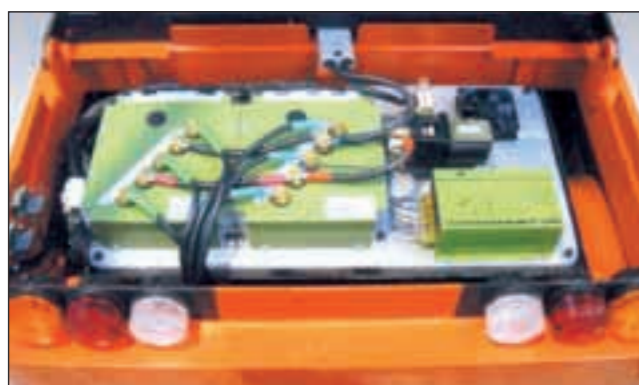
Potentes controladores de la frecuencia, consiguen un máximo control sobre la potencia y la velocidad.
